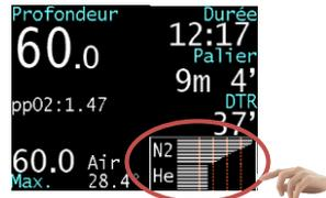
Le graphe de saturation en azote et hélium.
