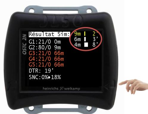
Le plan de décompression est affiché pour les mélanges actifs, avec la profondeur et la durée de chaque palier. La DTR est calculée : elle inclut le temps pour la remontée jusqu'au premier palier, la durée des paliers, le temps inter-palier. VDR : 10m/mn
