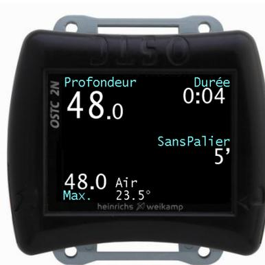
L'OSTC bascule en mode plongée en temps réel. Le simulateur tient compte des majorations liées aux plongées précédentes et à l'intervalle de surface.
