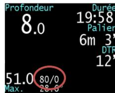
L'OSTC calcule la décompression en fonction des mélanges activés et des PMU saisies. Au bout de 15mn de temps au fond, il est temps de remonter, tu as un premier palier prévu à 9m pour basculer sur le mélange Nitrox.
