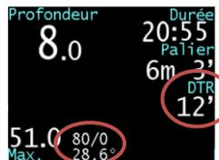
L'OSTC calcule alors le nouveau plan de décompression à partir du mélange sélectionné. La nouvelle DTR est basée sur ton mélange Nitrox.
