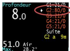
Mais, **si tu le souhaites**, tu as quand même la possibilité de sélectionner sous l'eau un mélange **inactif** dans la liste des gaz. Si tu choisis le mélange G2 inactif ...
